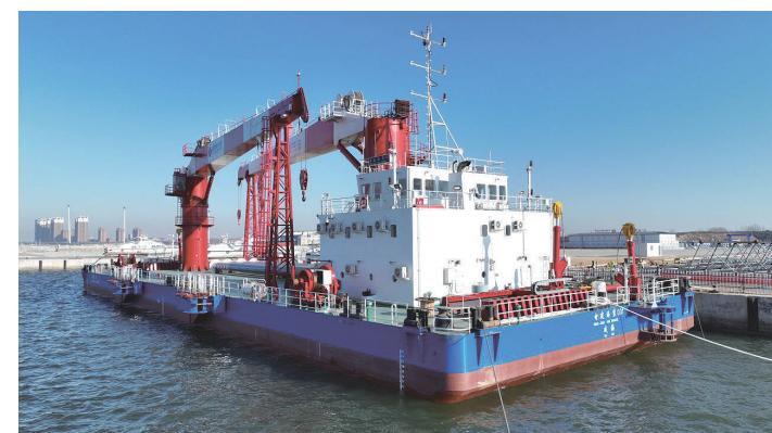
位工具进行了多型号适配式创新,使其能够适配不同直径的混凝土预制桩,满足光伏桩阵列布局需求。针对桩体精定位环节,装备结合北斗卫星定位、船位控制系统以及智能化软件,实现桩基喂桩、立桩、打桩全过程的精细化控制,以往桩体对位耗时长、易偏差的问题得到有效解决。
