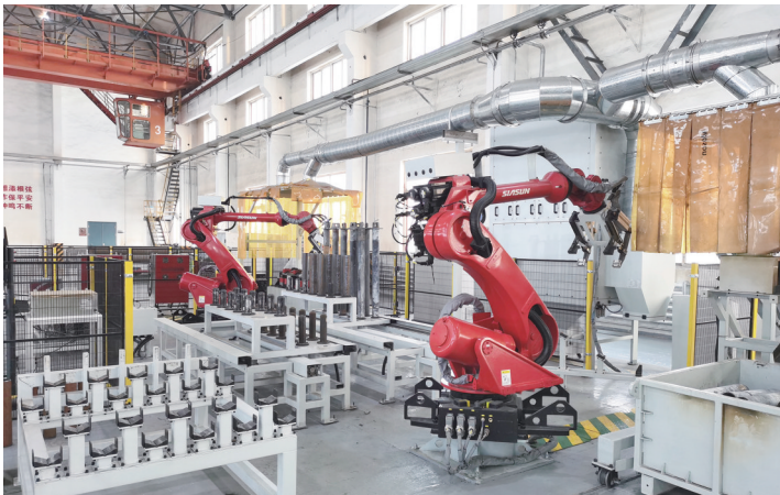
霍煤鸿骏铝电公司打壳锤头自动焊接系统
