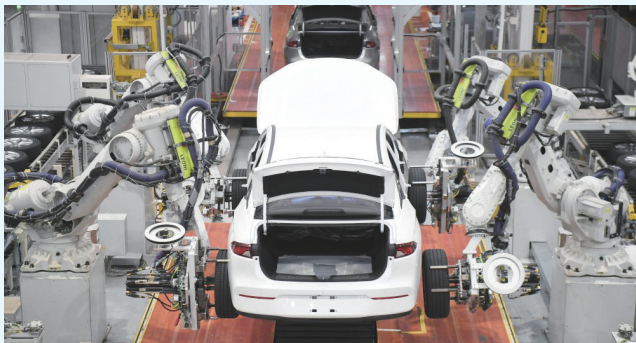
这是广州广汽埃安新能源汽车的全自动化轮胎安装工作站。
