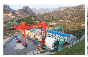
稳定、实时测量的导向技术。针对大直径(9.53米)、超小转弯半径(90米)工况下传统TBM无法实现小转弯掘进技术难题,提出了II型平行布置推进系统和油缸分布方案,首次实现通过推进系统四个分区油缸伸出量大行程调整,实现了TBM刀盘和支撑盾位姿精准调整。
