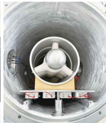
合电器关键绝缘件脉冲电流检测,大幅提升绝缘件微小缺陷的检测能力。研制的“声—电”融合的长时偶发局放带电检装置,已广泛应用于赣江站等14座特高压变电站,成功发现超、特高压组合电器缺陷37起,有效提高了组合电器缺陷检出率,推动了局放检测从频发大信号到偶发小信号检测技术的变革,获得了显著的经济效益和社会效益。
