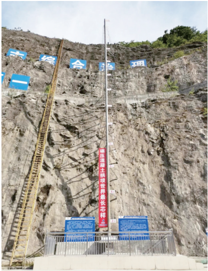
直径219毫米、长度为25.2米的碾压混凝土芯样
