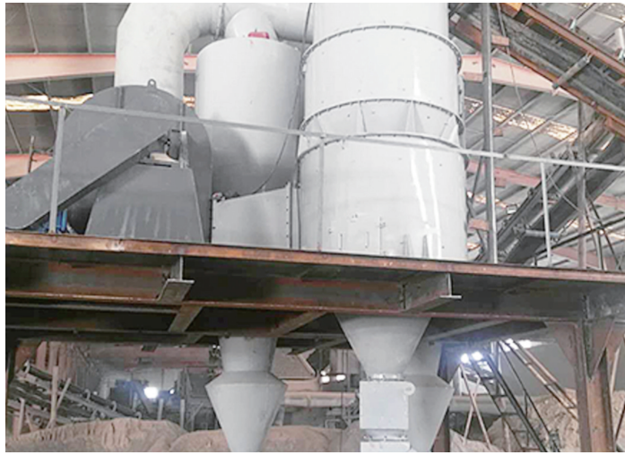
采用氮化硅陶瓷衬体的水泥选粉机输料口
