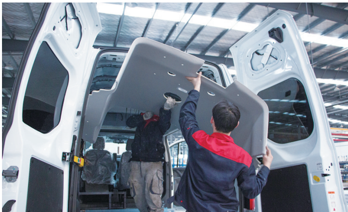
2月5日下午，奇瑞瑞弗首批20辆负压救护车交付。图为工人们正在进行内饰等配件的安装。
