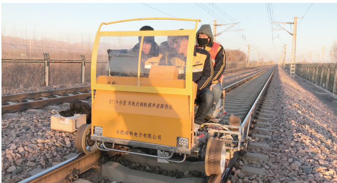
超科电子研发设计的双轨式钢轨探伤仪正在铁路上运行
