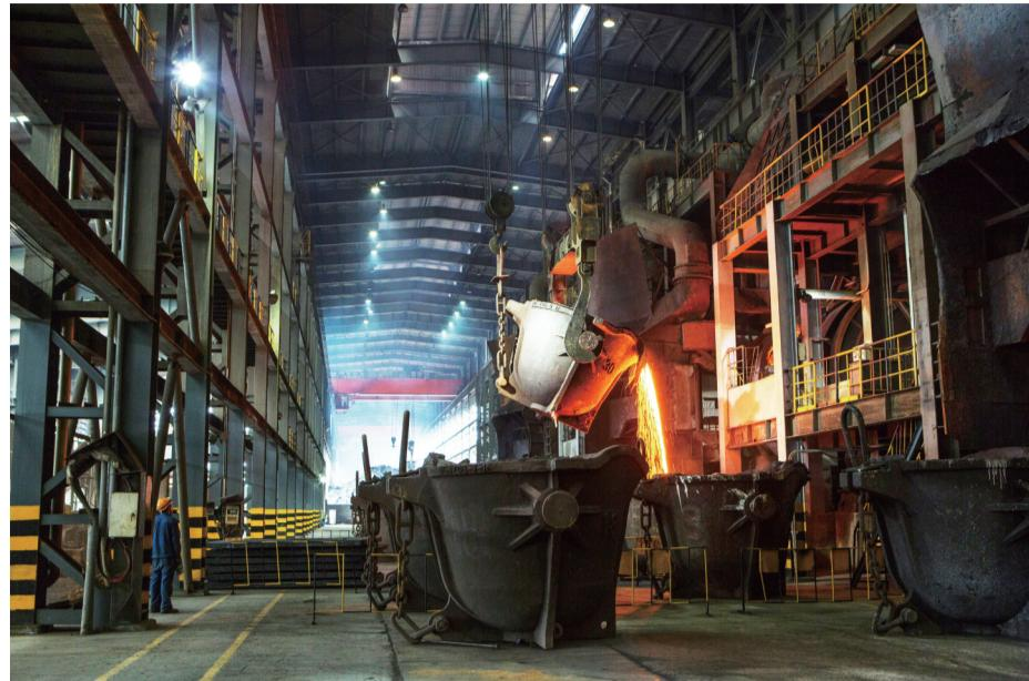
元炉+火精炉的“两步炼铜工艺”,在铜、金、银等有色金属及稀贵稀散金属的综合回收提取的过程中,充分发挥该工艺“搅动激烈、脱杂能力强、有价金属回收率高”的独特优势,广泛处理各种多金属复杂伴生矿料。
