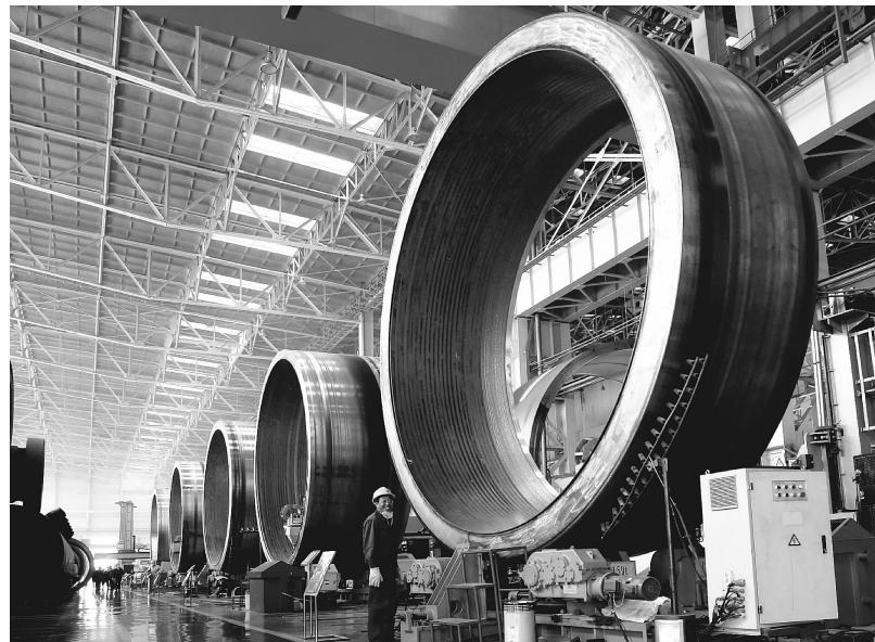
一重核电石化事业部双带极自动堆焊生产线
