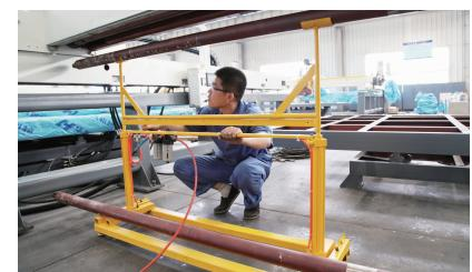
“轻举重达30公斤传动轴仅需15分钟就能装载到主横梁,人工托举安装传动轴的工序被‘接替’。”袁勇强自制“工装利器”——气动升降器,替代了人工托举后,人工减少,效率“翻番”。
