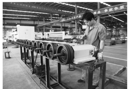
连续磨机的试机原先需要12个电机同时运转才能完成,现在只用一个电机就能完成。
