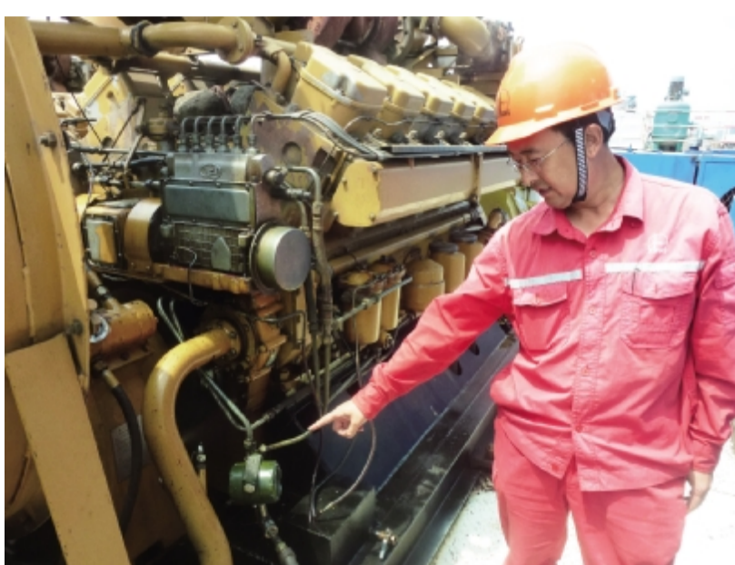
钻井队队长告诉记者，为获取详细数据和科学分析节能减排效果他们安装了流量计。
