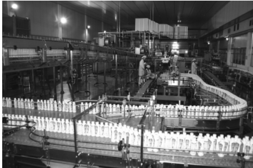
银鹭 PET 无菌冷灌装生产线一角
