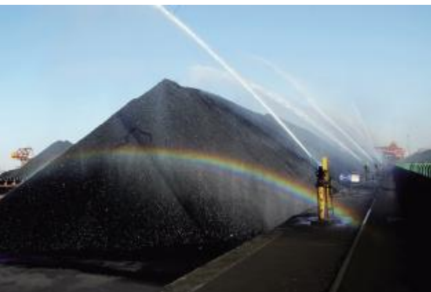
喷洒系统覆盖了秦皇岛港所有煤炭堆场
