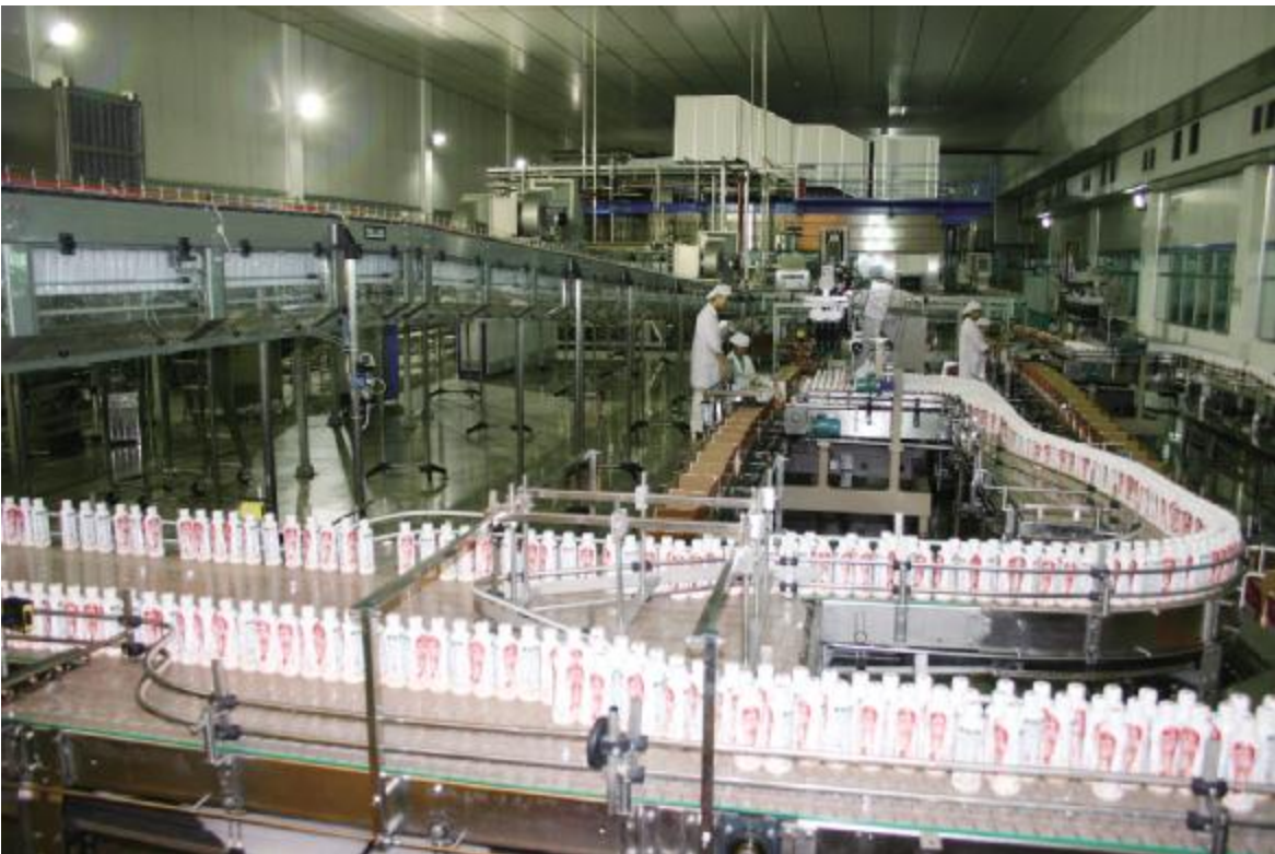
银鹭 PET 无菌冷灌装生产线一角
