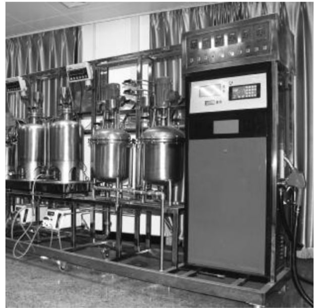
开滦煤化工研发中心自主设计开发的甲醇燃料在线调配装置
