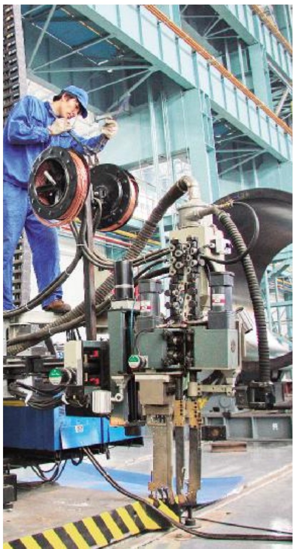
中国第二重型机械集团公司 重容分厂铆焊工人正在安装焊盘,调试设备性能
