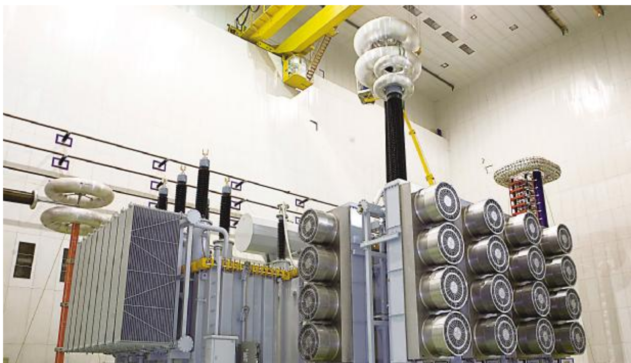
2010年9月,研制成功世界首台1000kV/1000MVA双柱结构特高压自耦变压器
