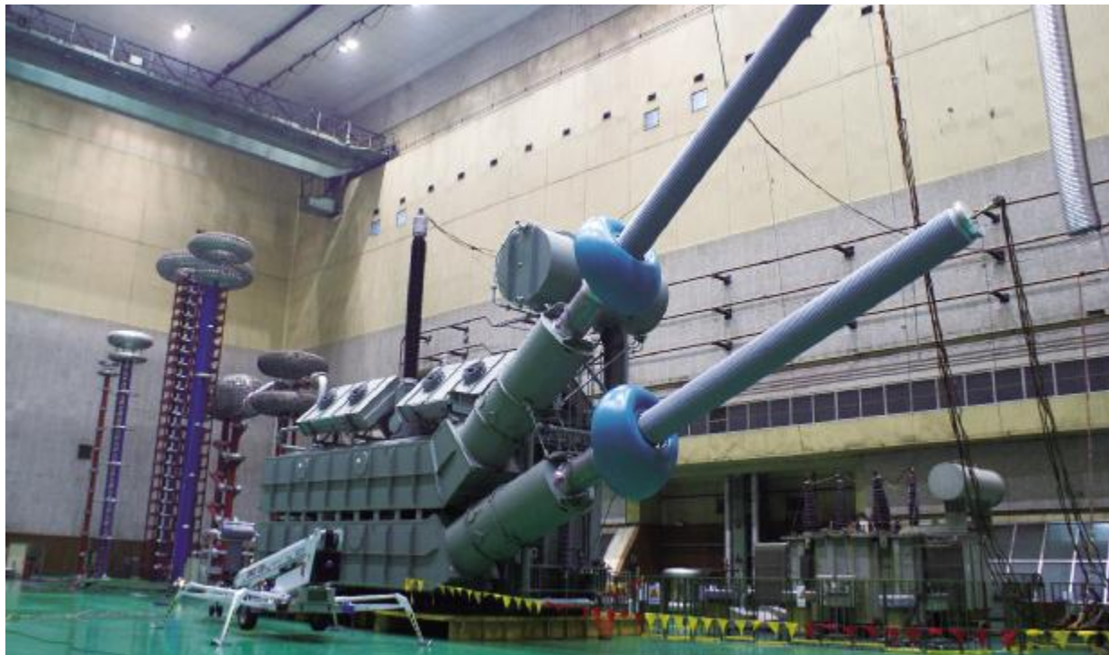
2010年研制成功世界首台 ZZDFPZ-250000 500-800 换流变压器
