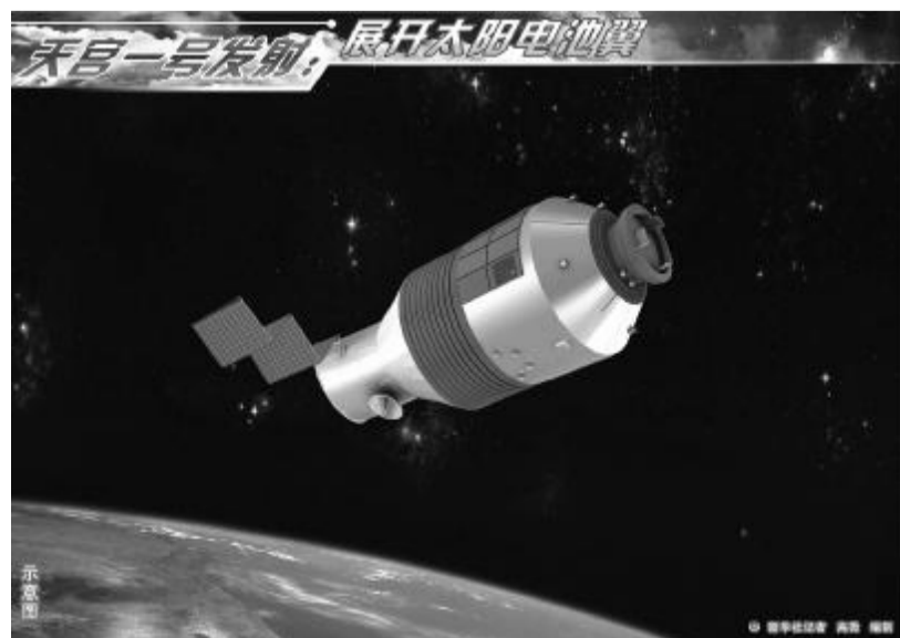
折板式太阳能电池板应用,是天宫一号电源系统采用的新技术之一。 新华社供图
