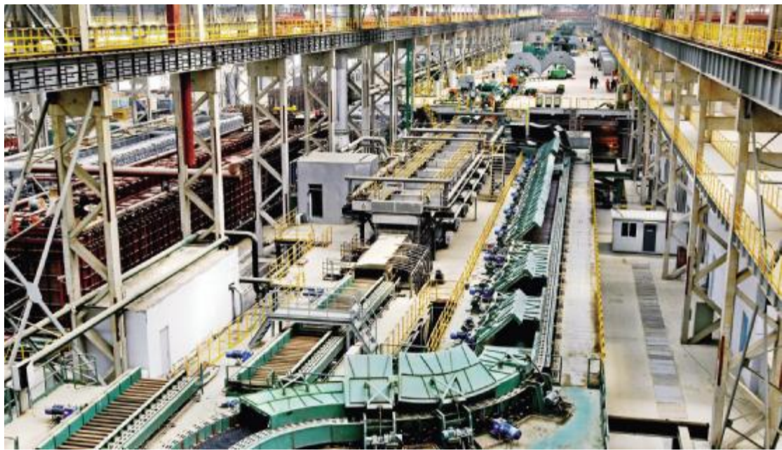
东北特钢大连基地合金钢高速线材生产线
