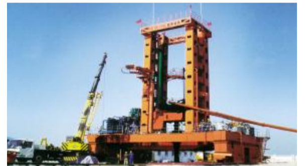
集团参与设计研制的AD130-1300型竖井钻机,是目前世界上钻井直径最大、钻井深度最深、综合性能技术指标最先进的新型竖井钻机
