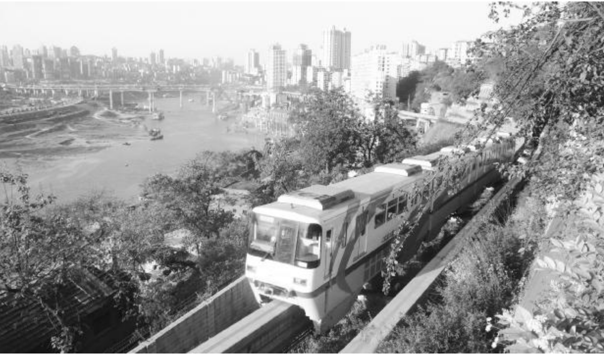
重庆轨道交通 2 号线：爬坡能力强、转弯半径小、噪音低、无排废污染
